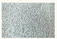
Isolation thermique le béton mousse est un excellent isolant thermique grâce à sa porosité caractérisée par des cellules d'air, c'est un matériau léger avec une densité modulable, cela permet de réduire les charges sur la structure porteuse.
