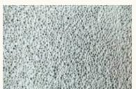
Isolation thermique le béton mousse est un excellent isolant thermique grâce à sa porosité caractérisée par des cellules d'air, c'est un matériau léger avec une densité modulable, cela permet de réduire les charges sur la structure porteuse.
