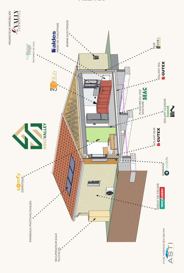
Les murs maçonnés de la construction seront réalisés avec des murs **CCB GREENTECH TimberRoc type CS2**. Panneaux en béton bois réalisés avec un mélange innovant composé d'eau, de granulats de bois provenant d'exploitants forestiers français certifiés PEFC et d'un ciment qui assure résistance et durabilité. Le béton bois contient
